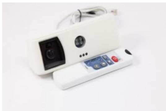
Wespot senge sensorer har vore nytta ved 5 tilfelle. Den er innstilt med ein sensor over senga som har markert inn senga. Wespot har ingen sensorar i sjølve senga, og er difor ikkje i vegen for brukaren. Sensoren vert skrudd av og på med fjernkontroll. Innstillinga på varsling kan individuelt tilpassast med at alarmen skal gå alt i frå at brukaren forlet senga eller etter ei bestemt tid etter at brukaren har forlat senga. Det er lite feilalarmer på denne og den har fungert som tiltenkt.
